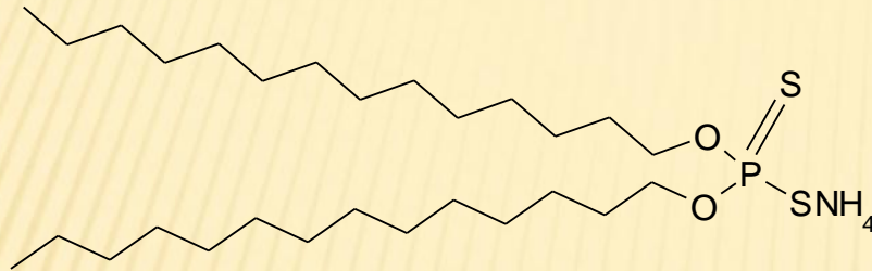
Digeoksadetsilditiofosfat ammonium (C_{16}H_{33}O)_2PS_2NH_4
